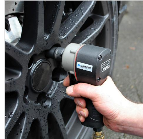
**7000** Avvitatore a impulsi ad aria compressa MiniMAX, 12,5 mm (1/2"): 678 Nm, MATADOR codice articolo: 70000011
