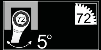
Umschwenkwinkel nur 5° durch 72 Zähne, schnelles Arbeiten auch bei beengten Platzverhältnissen.
