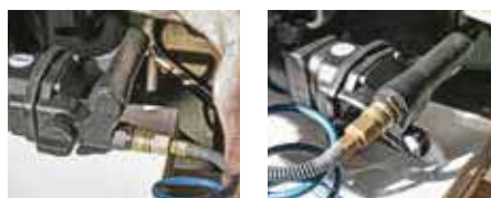
Zuluftführung wahlweise nach hinten oder nach unten
