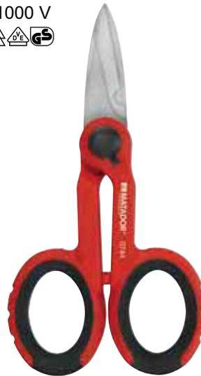
Coupe sans effort les câbles, les gaines de câbles, les attaches de câbles, le ruban isolant ou même le fil. Fabriqué en acier inoxydable INOX d'une dureté de 60 HRC. La lame est dotée d'une encoche pour les câbles et les fils.
