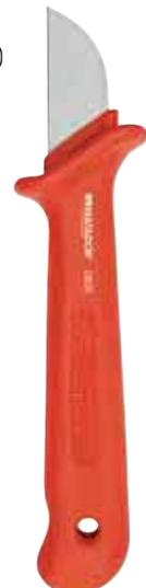
Couteau pour câbles VDE avec lame droite trempée en acier inoxydable. Capuchon de protection inclus pour éviter les blessures. Testé pièce par pièce à 10.000 V avec surface isolée selon IEC 60900:2004.
