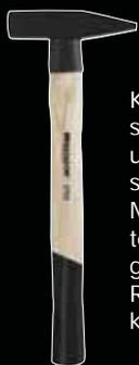
Kopf gesenkgeschmiedet, Bahnen und Pinne fein geschliffen und poliert. Mit angeschmiedetem Stielschutzkragen und Nylonhülse. Ringverkeilt und rot kunstharzvergossen.
