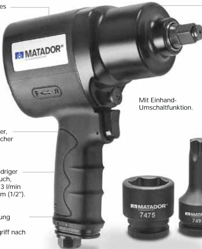
Hochleistungs-Doppelhammer-Schlagwerk aus 2 Ambossen mit neu entwickeltem Twin-Line-Mitnehmer der Extraklasse. Für hohe Lösemomente bereits mit den ersten Umdrehungen.
