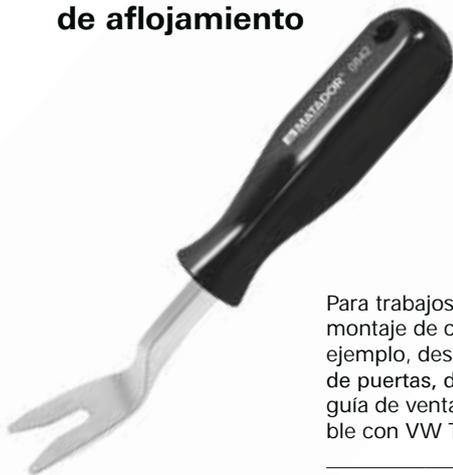
Para trabajos generales de montaje de carrocerías, por ejemplo, desmontaje de paneles de puertas, de cristales fijos con guía de ventana, etc. Comparable con VW T10236.
