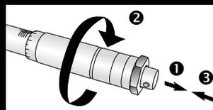
Fácil desbloqueo y ajuste del valor de par deseado girando la empuñadura.
