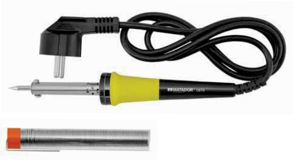
Soldador universal con 40 W para mayores necesidades de calor, probado millones de veces. Versátil para tareas de soldadura en las áreas de artesanía / servicio y hobby. Equipado con una punta de soldadura permanente profesional. Conforme a la directiva ROHS, con una tensión de funcionamiento de 230 V y un tiempo de calentamiento de 120 segundos. Temperatura máxima de la punta de soldadura de 420 °C. Diámetro de la punta de soldar 3,10 mm.
