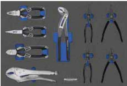
Alicates combinados, alicates para teléfonos, alicates de corte lateral, alicates para bombas de agua, alicates para circlips A2 - A21 - J2 - J21, alicates de agarre 250 MM / 10".
