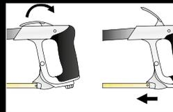
Dispositivo de sujeción rápida con una sola mano.
