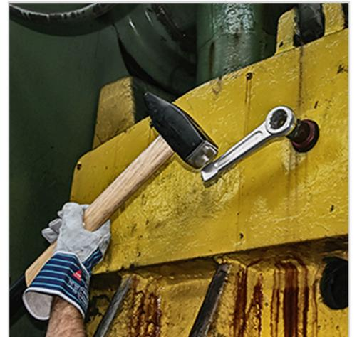
**0270** Schlag-Ringschlüssel, 60 mm, MATADOR Art.-Code: 02700600**Beschreibung:****Schlag-Ringschlüssel nach DIN 7444.**
